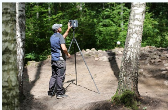
8. Porzuciliśmy tradycyjny rysunek na papierze – każdą z warstw skanujemy. Dla trójwymiarowych struktur to jedyna, wiarygodna metoda dokumentacji.
