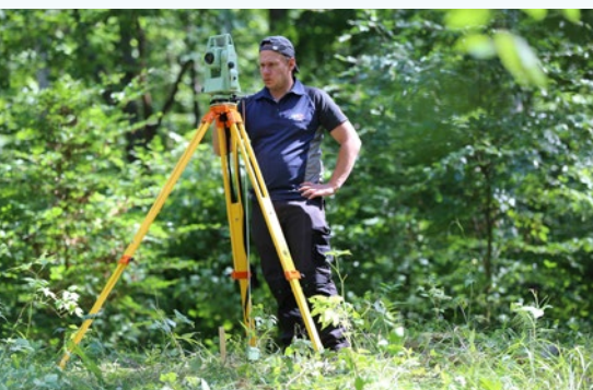
4. Oczyszczony nasyp dokumentujemy – wykonujemy plan wysokościowy z użyciem tachimetru elektronicznego i skanujemy laserowo.
